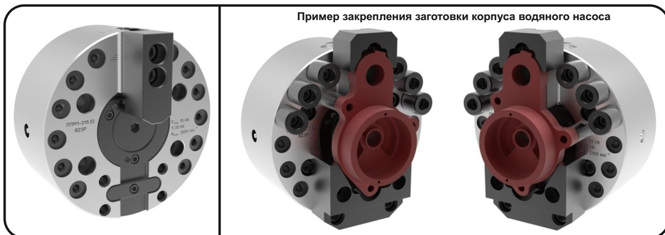
Патроны предназначены для закрепления штучных заготовок сложной конфигурации, несимметричных, эксцентриковых (отливки, поковки и т.п.) обрабатываемых на станках токарной группы в условиях серийного и массового производства.
