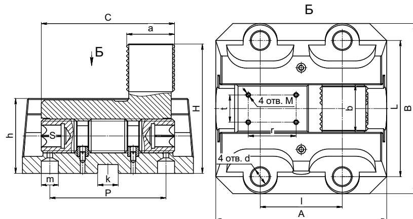
Кулачки зажимные предназначены для установки на токарно-карусельные станки. На кулачках можно выполнять многоинструментальную обработку крупногабаритных заготовок, одновременно используя несколько инструментов, что во многом облегчает работу и повышает производительность.
