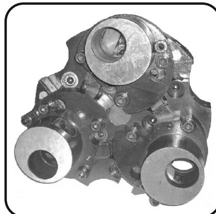
Головка предназначена для установки шести резцов сечением 25x25 мм и трех резцедержателей с цилиндрическим хвостовиком диаметром 50 мм, устанавливаемых в спецблоки на головку.
