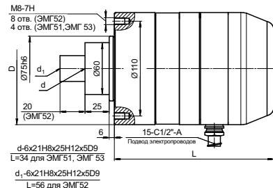
Головки ЭМГ предназначены для механизированного зажима инструмента в шпинделях фрезерных, расточных и других станков, привода кулачков токарных патронов, перемещения пинолей задних бабок. Головки могут встраиваться как во вновь создаваемое оборудование, так и при модернизации действующих станков.
