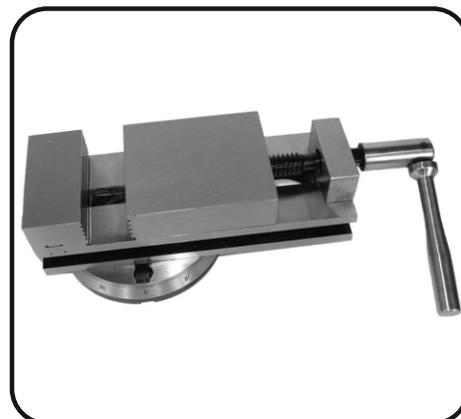
Тиски станочные поворотные с ручным приводом предназначены для закрепления заготовок при механической обработке на металлорежущих станках.
